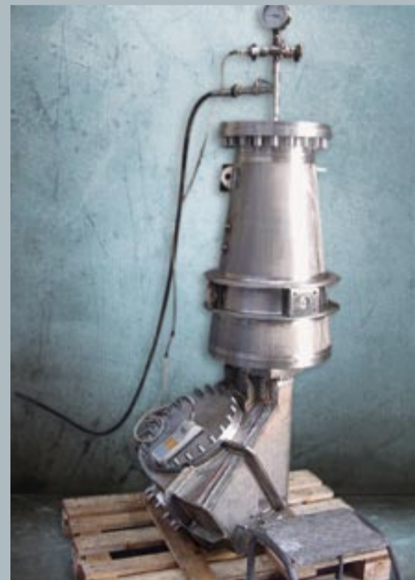
Druckprüfung bei 32 bar, Betriebstemperatur 450° C, Werkstoff 1.4541
