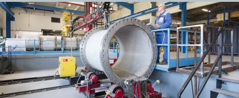
UP-Schweißen von Messrohraufnehmer bis \text{D}_{\text{m}} 2400 mm und Blechdicke 50 mm
